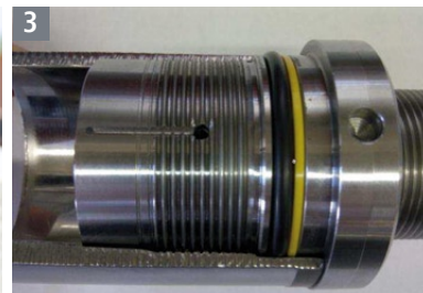
Tłok z widocznym kanałem obejściowym oleju
